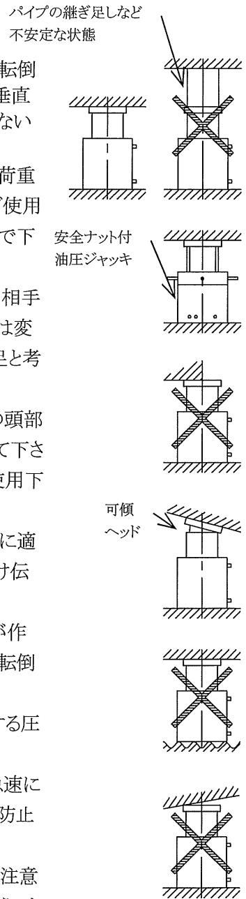
⑩△警告 荷重受部及びジャッキベースには滑らないように適宜摩擦材(板)を挟んで下さい。
